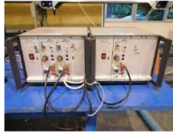
Gambar 5. Wave Monitor yang terhubung dengan komputer
